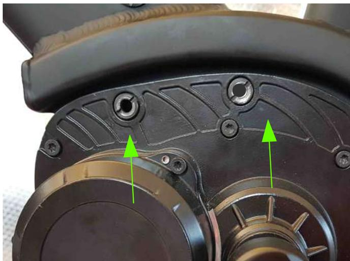
Svitare con un grosso cacciavite anche le due bocche indicate dalle frecce verdi
